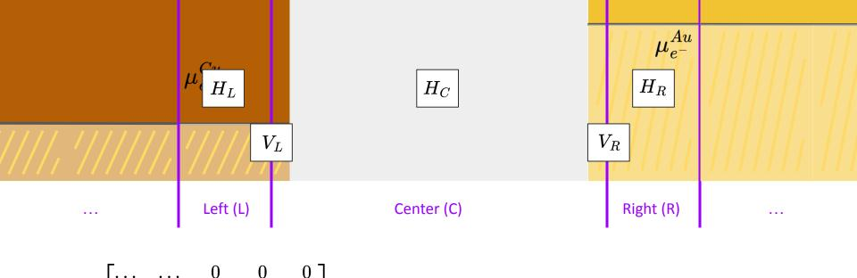
$$H = egin{bmatrix} \ldots & \ldots & 0 & 0 & 0 \ \ldots & m{H_L} & V_L & 0 & 0 \ 0 & V_L^\dagger & H_C & V_R & 0 \ 0 & 0 & V_R^\dagger & m{H_R} & \ldots \ 0 & 0 & 0 & \ldots & \ldots \end{bmatrix}$$
