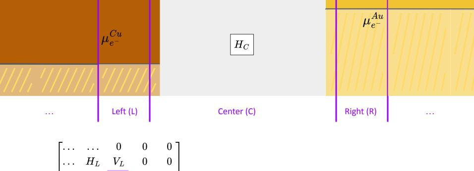
$$H = egin{bmatrix} \ldots & \ldots & 0 & 0 & 0 \ \ldots & H_L & V_L & 0 & 0 \ 0 & V_L^\dagger & H_C & V_R & 0 \ 0 & 0 & V_R^\dagger & H_R & \ldots \ 0 & 0 & 0 & \ldots & \ldots \end{bmatrix}$$
